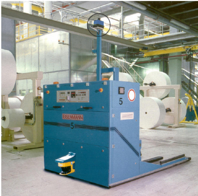
Abbildung 1.1: Der Nav200 wurde auf einer langen Stange montiert, damit er die Reflektoren sehen kann. [6]
