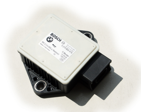
Abbildung 2.4: Der Bosch MM3 ist ein Sensorcluster mit Beschleunigungs- und Drehratensensoren
