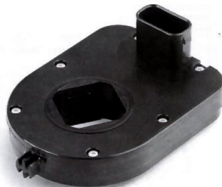
Abbildung 2.3: Der Lenkwinkelsensor LWS40 liefert die Winkelstellung der Lenkachse mit einer Genauigkeit von 0,1^\circ
