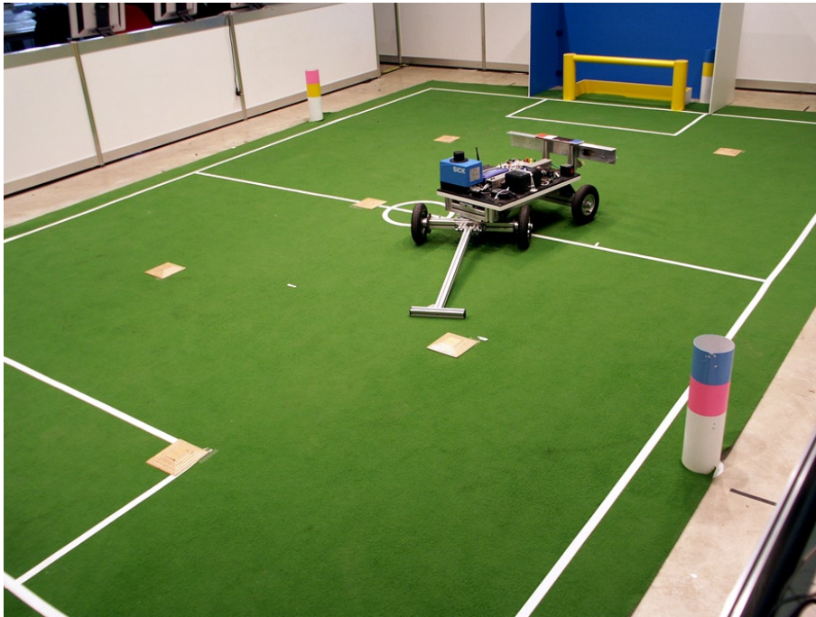
Abbildung 6.1: Testaufbau zur Aufzeichnung der Testdaten. Das Feld ist 6m x 4m groß. Es wurden 6 Magnete verwendet, die in abgeschrägte Holzbretter eingebaut wurden.
