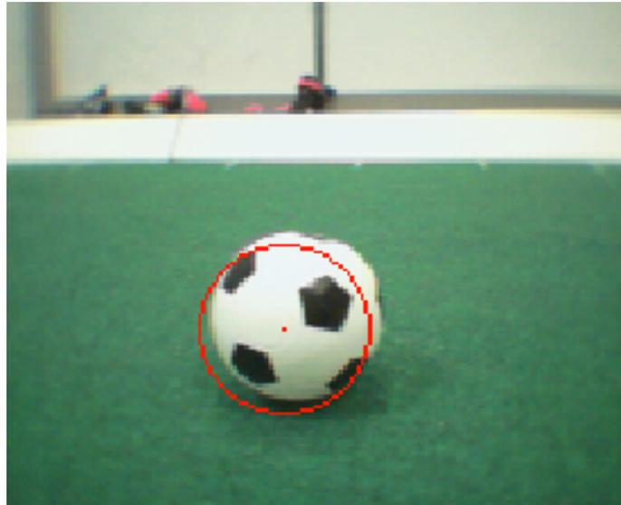
Abbildung 8.10: Durch die Quantisierung des Parameterbereichs ist die erkannte Form (roter Kreis) gelegentlich ein wenig verschoben. Hier wird der Radius des Balles zwar gut erkannt, aber die Lage des berechneten Mittelpunktes ist gegenüber dem Mittelpunkt des Balles um einige Pixel nach links-unten verschoben.
