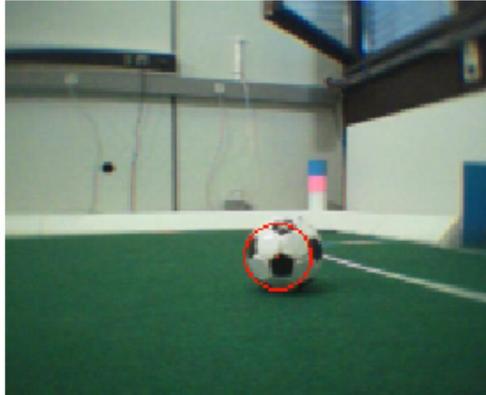
Abbildung 8.9: Der Radius des in der Mitte des Bildes befindlichen schwarz-weißen Balles wird zu klein erkannt.
