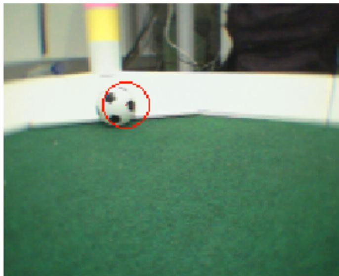
Abbildung 8.11: Der Ball liegt direkt vor der weißen Bande. Im Hintergrund ist eine Landmarke zu erkennen. Da keine Abgrenzung zwischen den Weißtönen der Bande und des Balles möglich ist, wird der Ball hier zu groß erkannt.
